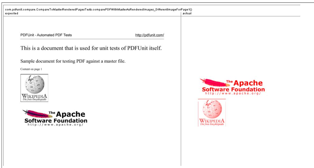
Die Überschrift dieses Diff-Bildes enthält den Namen des Tests und in der Fehlermeldung wird der Name des Diff-Bildes genannt. So ist eine Querverbindung zwischen Test und Fehlerbild gegeben.
